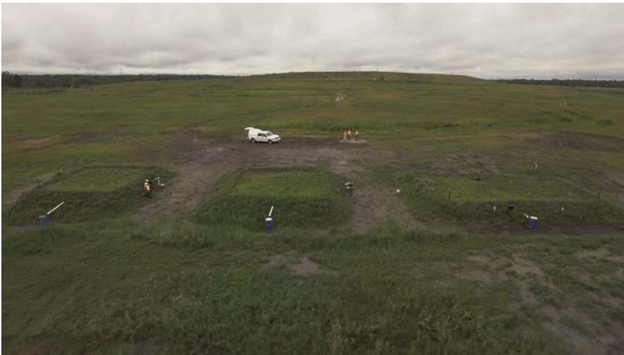
Lysimètres pour déterminer infiltration Site d'enfouissement de St-Nicéphore 20018-2021
