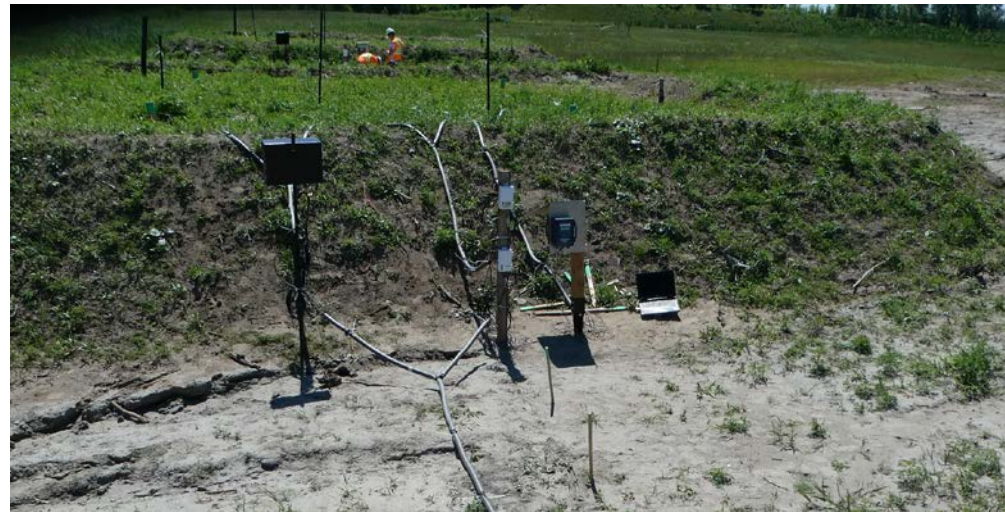
Lysimètres pour déterminer infiltration Site d'enfouissement de St-Nicéphore 20018-2021
